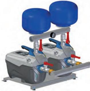
Nel funzionamento in gruppo, la pressione di riferimento si può impostare solo sull'inverter MASTER, gli inverter in autonomia a seconda della quantità d'acqua richiesta dalle utenze, regolano il funzionamento di una o due pompe a seconda della necessità.
